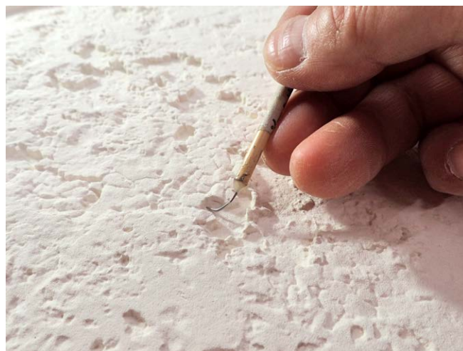
▲【写真3】手加工の様子。機械では削り取れない部分を、データと照らし合わせながら手で削る。
