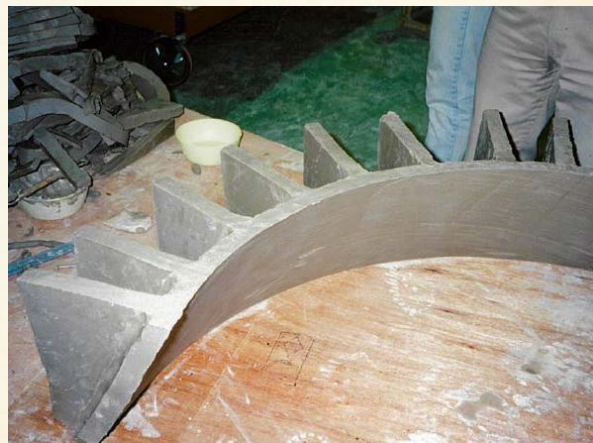
▲【写真3】窓枠内側はテラコッタで製作。窓枠外の支えはひずみ防止、施工現場で役立っている。
